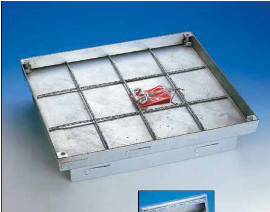
Type BVS-400 Onderkant van het tegeldekseksel versterkt met een extra omran- ding, I-balken en staalplaat.
