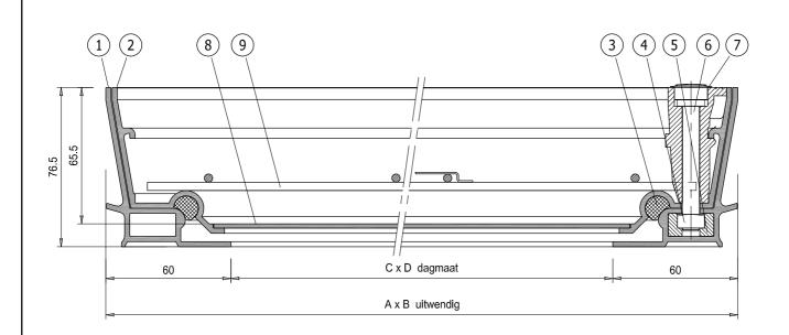
Binnenmaat putomranding  $C \times D = 800 \times 600 \text{ mm}$ Uitwendige afmeting  $A \times B = 920 \times 720 \text{ mm}$
